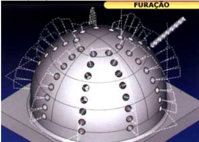
As operações de furação, mandrilamento, rosqueamento, etc, estão ainda mais automáticas na nova versão. O UniCAM identifica automaticamente os furos por diâmetro ou por cor e nestes furos são aplicados os ciclos fixos do CNC, inclusive com gerenciamento da mesa giratória.
