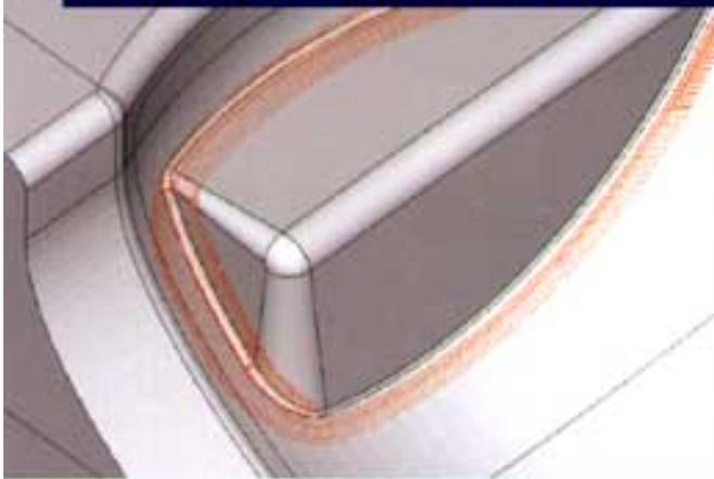
O percurso da ferramenta calculado na **Retomada de Material Remanescente** é realizado automaticamente e pode ser executado de dois modos.
