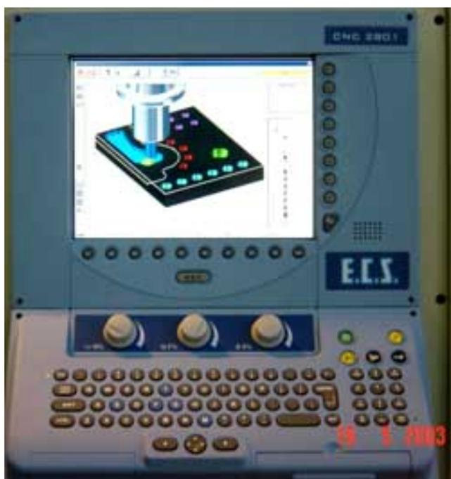
Como o **CNC ECS** possui uma arquitetura aberta, o UniCAM roda dentro do ambiente do próprio comando. Enquanto o CNC ECS controla a máquina ferramenta, o usuário pode desenvolver, processar e simular programas UniCAM.
